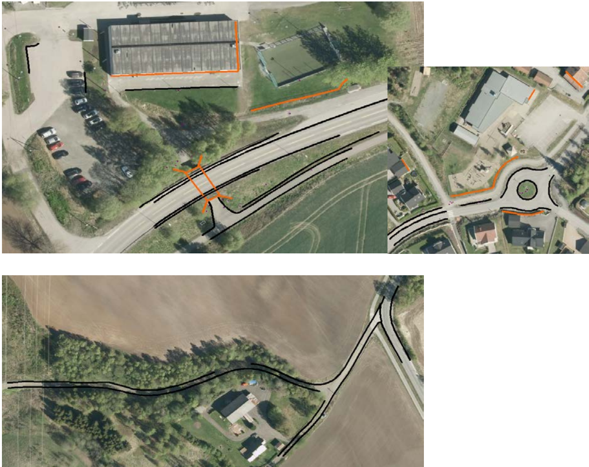
Landmålte fasitdata FKB-B - Vegsituasjon (svart), Takkant, AnnetGjerde og MurLoddrett (oransje), EL_belysningspunkt og Kumlokk (lilla). Nederste bilde viser landmålt grusveg.
