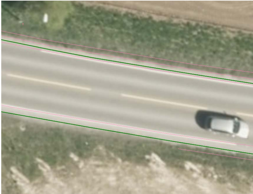
Firma B: Sammenfallende Vegdekkekannt og Vegskulderkant i grønt nede, Kjørbanekant i rosa i vegflaten, oppe ser vi i rekkefølge (ned ifra og opp) Kjørrebanekant, Vegdekkekannt, Vegskulderkant og Åpenvegggrøft.
