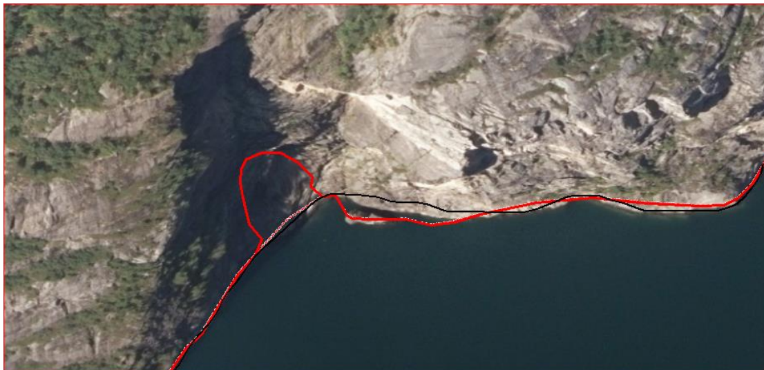
Eksempel på område hvor ny kystkontur er konstruert. Feil kystkontur er rettet. (rødt gammelt/sort nytt)
